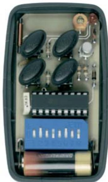
Fig.8 Esquema práctico de montaje del Transmisor (izquierda). En la parte superior-derecha se encuentra el compensador C3, utilizado para el ajuste de la frecuencia. Fotografía del Transmisor LX.1651 una vez completado el montaje de todos sus componentes (derecha).
