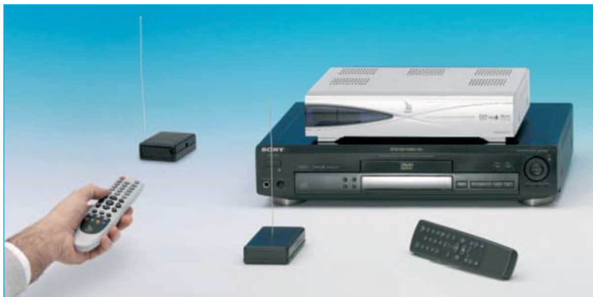
Fig.1 El Repetidor RF para mandos a distancia está compuesto por un Transmisor (TX) que recibe la señal infrarroja del mando de distancia y la transforma en una señal de radiofrecuencia, y por un Receptor (RX) que capta la señal RF emitida por el Transmisor y la reconvierte en infrarroja para controlar un decodificador TV, un videograbador o un reproductor DVD.
