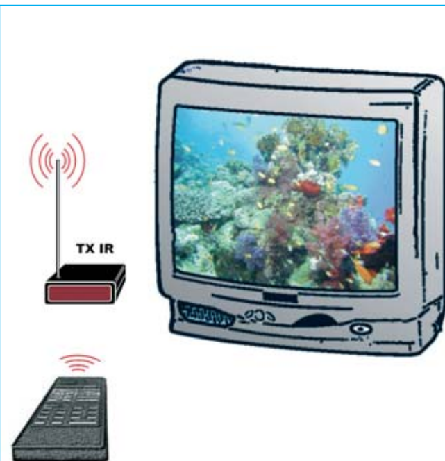
Fig.3 Si no se dispone de una toma de antena a la que conectar el televisor se puede ver la TV en puntos diferentes de la vivienda utilizando Transmisor-Receptor de Audio/Vídeo a 2,4 GHz (LX.1557-LX.1558) presentado en la revista N°232.
