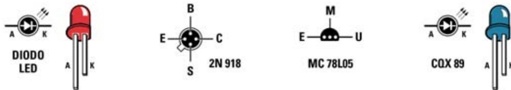
Fig.11 Conexiones del diodo LED DL1 y del diodo LED infrarrojo CQX89, en ambos el ánodo corresponde al terminal más largo. Las conexiones del transistor 2N918 y del regulador de tensión MC78L05 se muestran vistas desde abajo.
