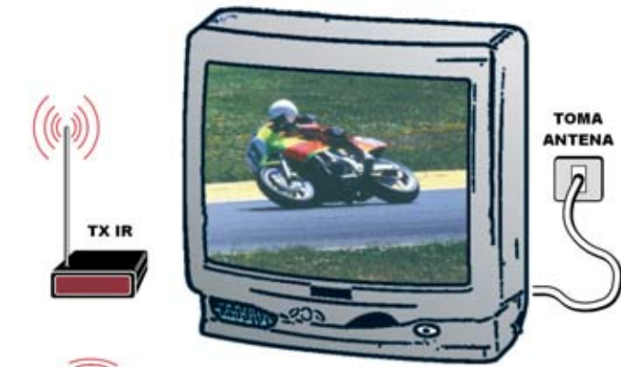
Fig.2 El Repetidor para mandos a distancia permite controlar a bastante distancia decodificadores TV, videograbadores, reproductores DVD o cualquier dispositivo controlado con un mando por infrarrojos.
