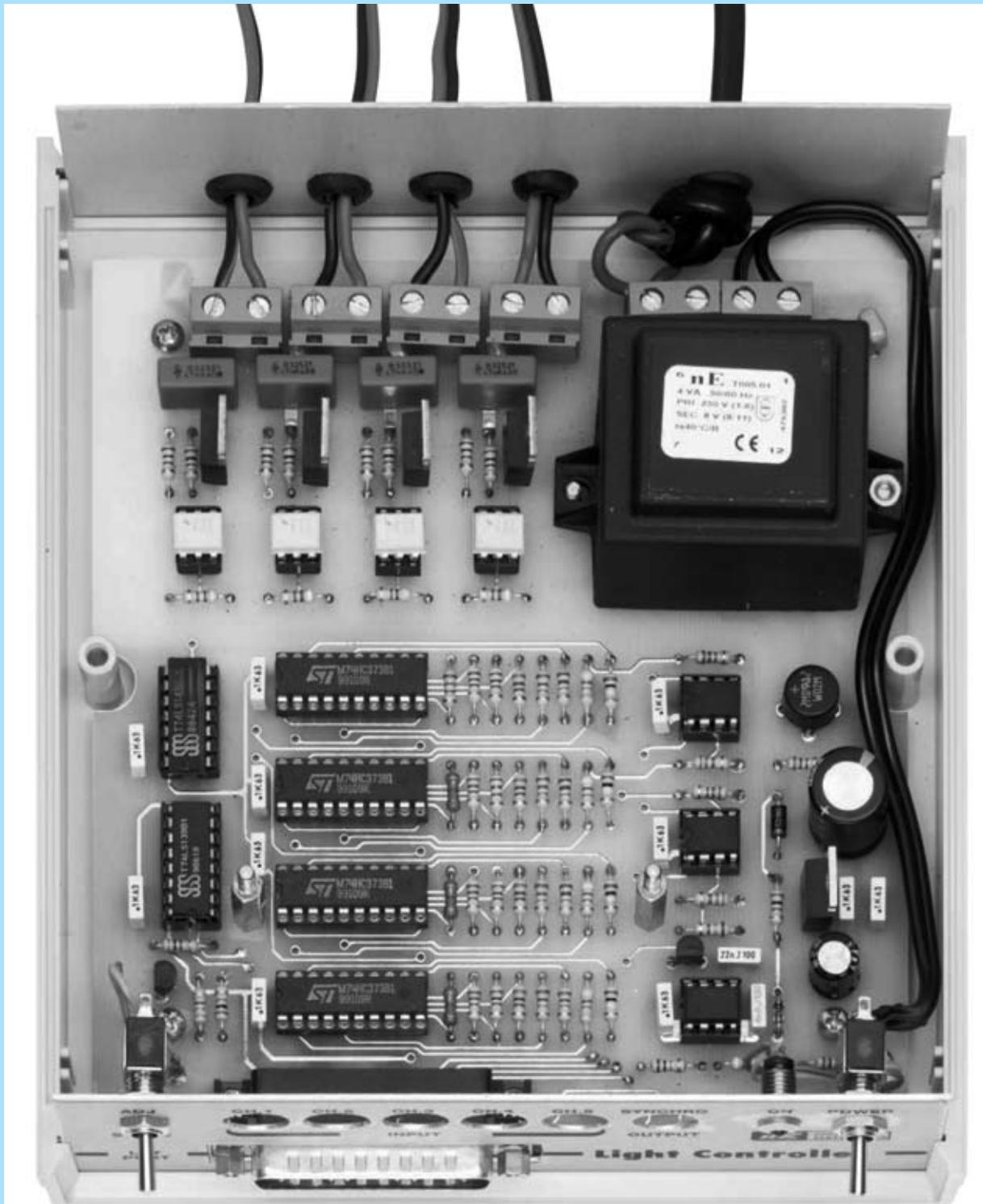
Fig.12 Fotografía de la tarjeta LX.1613 instalada en el mueble plástico. Antes de insertar el circuito hay que montar, en el panel frontal, el interruptor de encendido, el conmutador y el portaled metálico con su correspondiente diodo LED. Una vez instalado el panel frontal con sus componentes se puede instalar la tarjeta en la base del mueble haciendo salir el conector macho de 25 polos por su correspondiente agujero.
