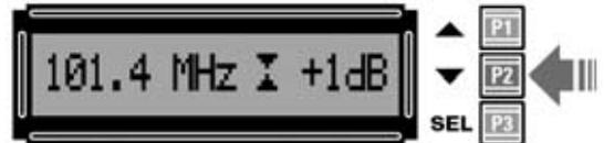
Fig.23 Para disminuir la frecuencia de transmisión únicamente hay que pulsar la tecla central (P2).
