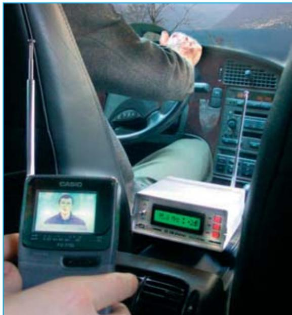
**Fig.5 Conectando el Excitador FM a la toma de audio de un pequeño televisor portátil se puede utilizar el equipo Hi-Fi de vuestro coche o autocaravana para potenciar el sonido.**
