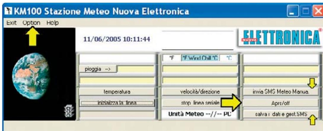
Fig.19 Aspecto de la ventana principal del programa WEATHERDATA. Además de las funciones del programa presentadas en la revista N.244 se pueden mandar los datos meteorológicos a la red APRS y recibir los mismos datos en un teléfono móvil en forma de mensajes SMS.
