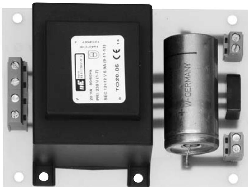
Fig.7 Fotografía de la etapa de alimentación una vez completado el montaje. Este alimentador, que proporciona una tensión de unos 32 Voltios y una corriente de 0,9 Amperios, también puede ser utilizado para alimentar otros circuitos que precisen estos valores de tensión y corriente.
