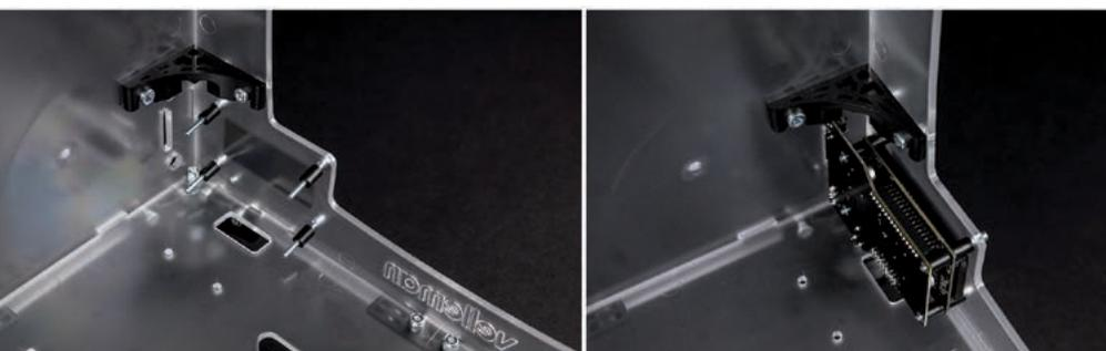
**Fig. 15** - Montaje del panel de control de la impresora.
