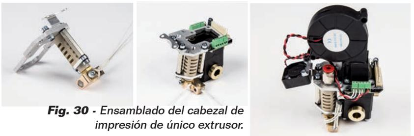
**Fig. 30** - Ensamblado del cabezal de impresión de único extrusor.
