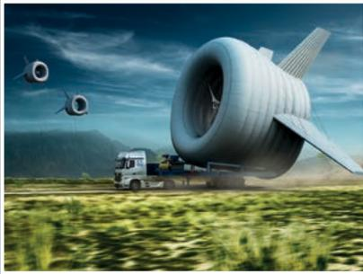
El equipo de investigadores de Altaeros Energies, una innovadora start-up del Massachusetts Institute of Technology (MIT), ha fabricado el Buoyant Air Turbine (BAT), una turbina eólica flotante, que produce energía limpia incluso a mil o dos mil metros del suelo.
