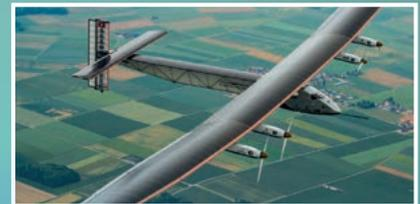
surizada ni calefactada, ya que la energía necesaria para esas dos funcionalidades se reduciría de la propulsión y no permitiría completar la hazaña. Las 17.248 células solares integradas en las alas, en las horas de luz proporcionan la energía a los cuatro motores eléctricos de 17,5 CV de alta eficiencia (94%) cada uno y recargan
