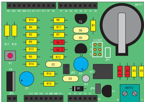
*Al shield va conectada la batería: las tiras de pines llevan la alimentación a Arduino cuando debe despertar el sistema.*
