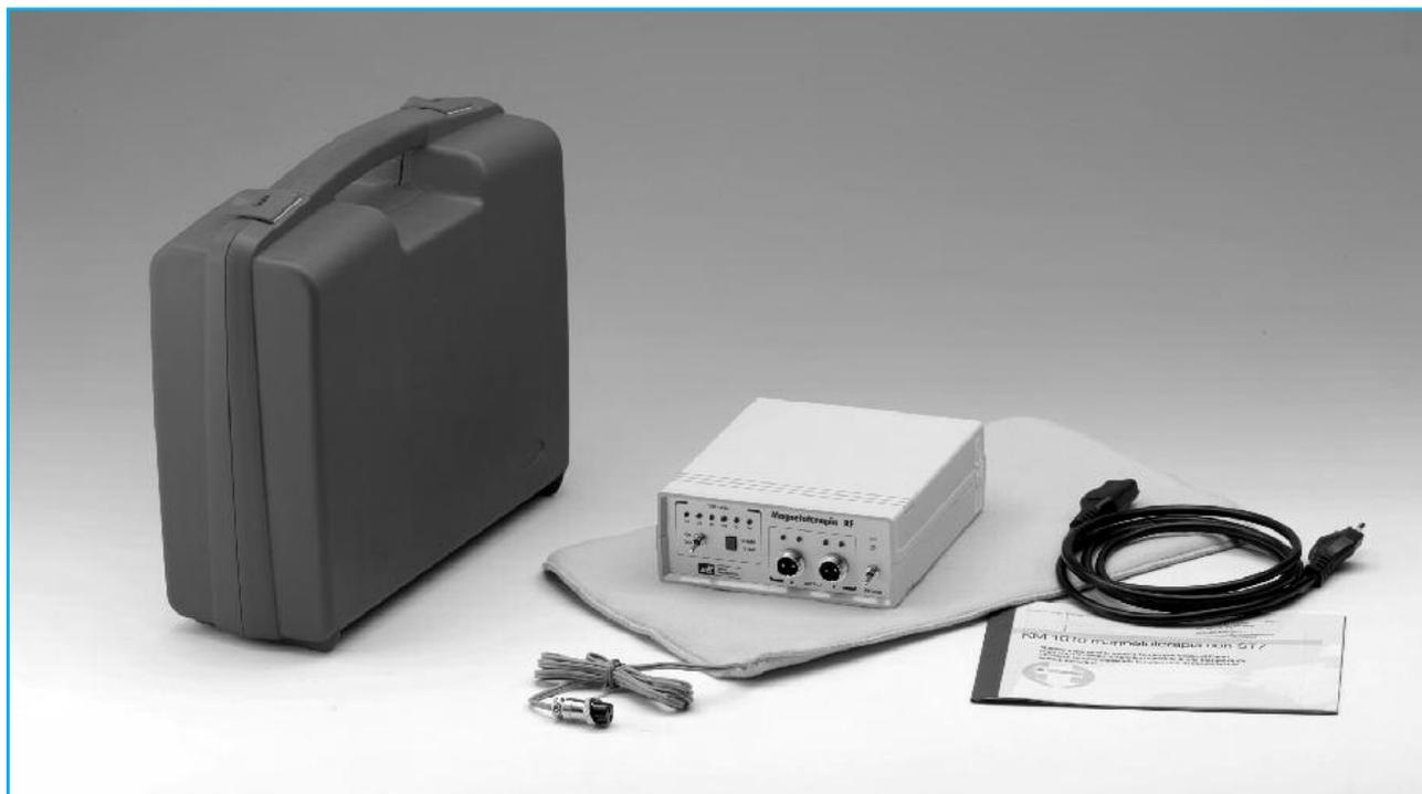
La característica principal de esta magnetoterapia es la utilización de un **microcontrolador ST7** que se encarga de modificar de forma **automática el ciclo secuencial** de las siguientes frecuencias: **156 - 312 - 625 - 1.250 - 2.500 pulsos por segundo**
