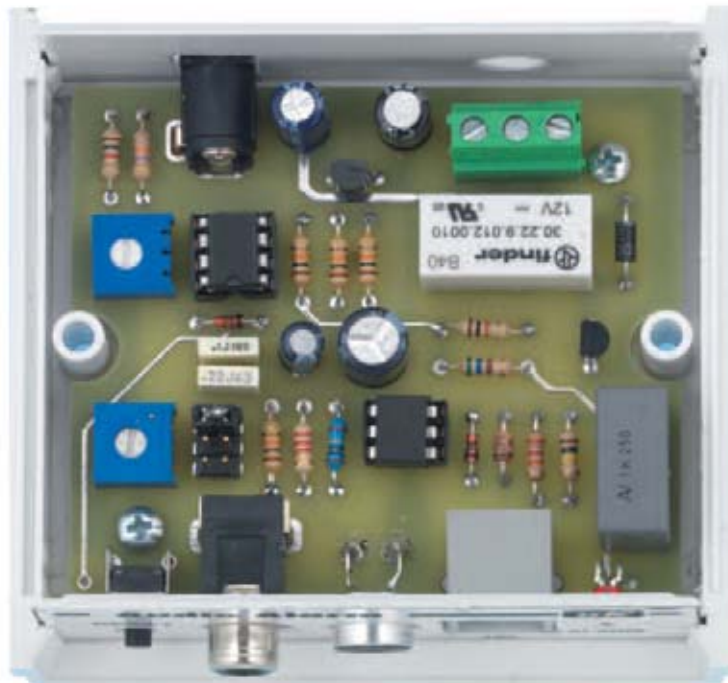
Fig.6 En esta foto se puede ver el circuito del dispositivo LX.1781 montado en el interior del chásis de plástico.
