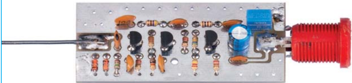
Fig.3 Esquema de montaje del LX 1777. La longitud de la antena puede ser incluso de más de un metro. En ese caso, es evidente que el tubo de protección debe tener una longitud adecuada para contener junto con el circuito del amplificador. A continuación, foto del circuito después del montaje.
