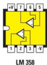
Fig.8 Conexiones del integrado LM358 vistas desde arriba y con la marca de referencia a la izquierda, el integrado LM317 y el diodo LED vistos frontalmente.
