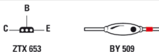
Fig.2 Conexiones del transistor ZTX653 vistas desde abajo y del diodo de alta tensión BY509. Para localizar el terminal + de este diodo, ver fig.4.
