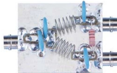
Por otro lado, para que no se produzcan desequilibrios, es esencial que los 4 cables que conectan las 2 salidas del divisor y las 2 entradas del combinador tengan todas la misma longitud.
