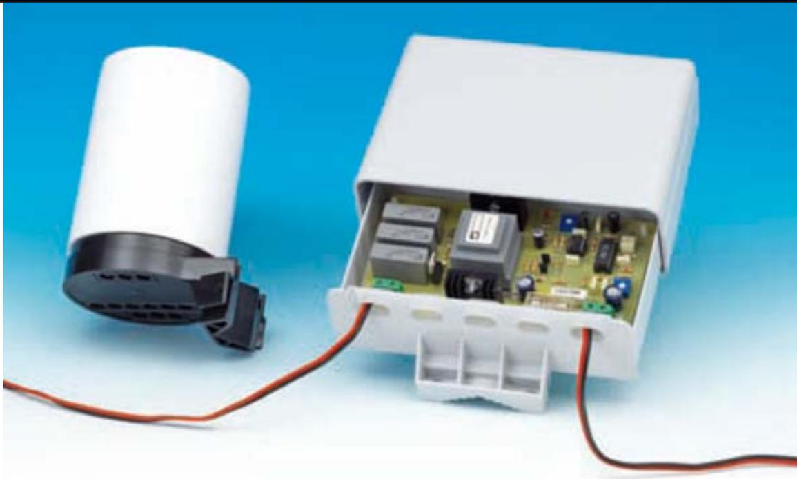
**Fig.11 en la fotografía se puede ver el contenedor de la tarjeta LX.1759 y el contenedor en el que se coloca la bobina de alta tensión. Ambos pueden fijarse verticalmente en una estaca del cercado, garantizando al generador una buena protección ante la lluvia y los agentes climáticos.**
