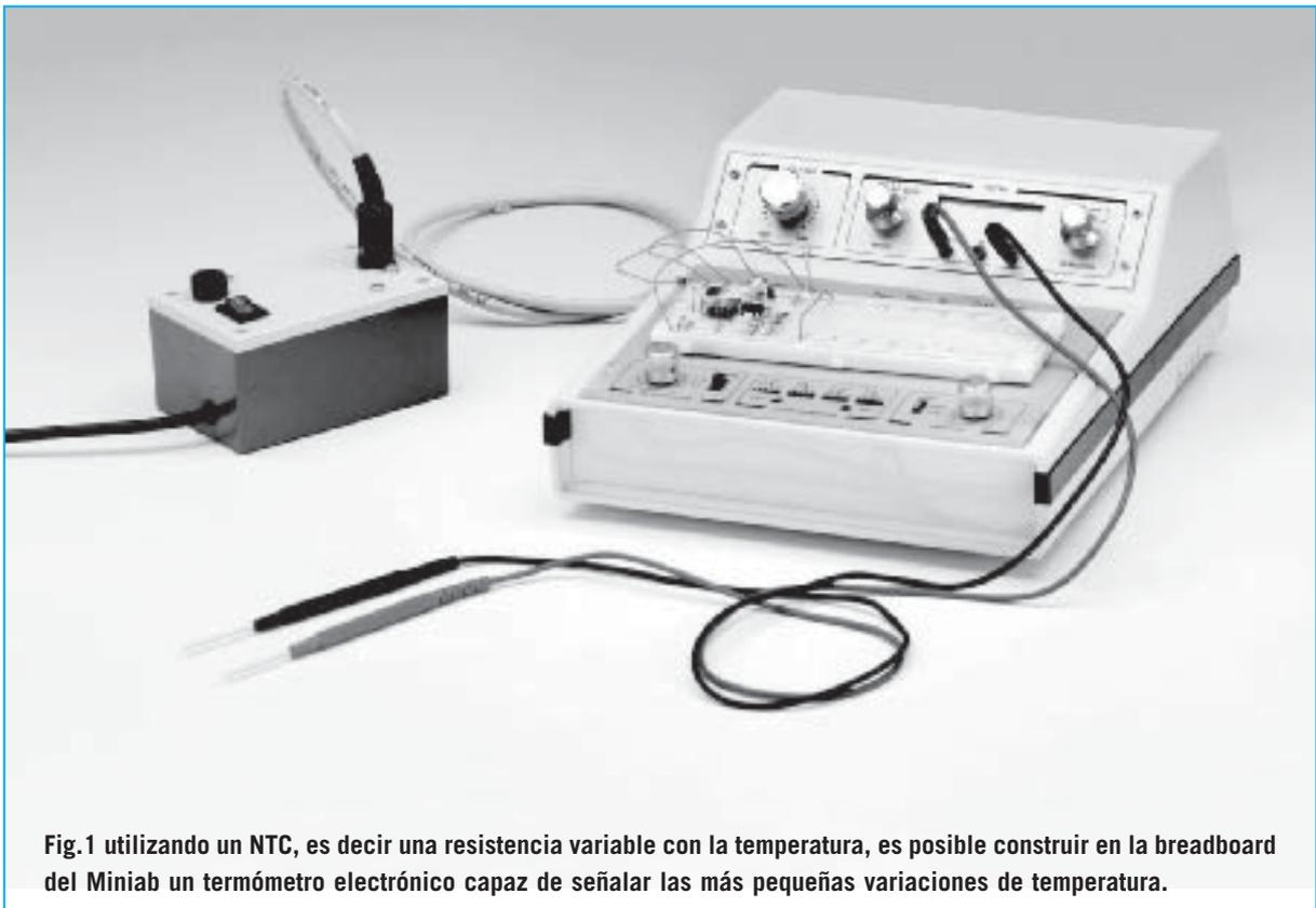
Fig.1 utilizando un NTC, es decir una resistencia variable con la temperatura, es posible construir en la breadboard del Miniab un termómetro electrónico capaz de señalar las más pequeñas variaciones de temperatura.
