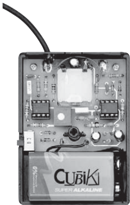
Fig.6 en la figura reproducida a la izquierda se ve el pequeño circuito impreso del skin detector situado dentro del contenedor. En el centro se ve la parte trasera del microamperímetro, y debajo el trimmer utilizado para el calibrado. A la derecha, el interior de la sonda de medición.
