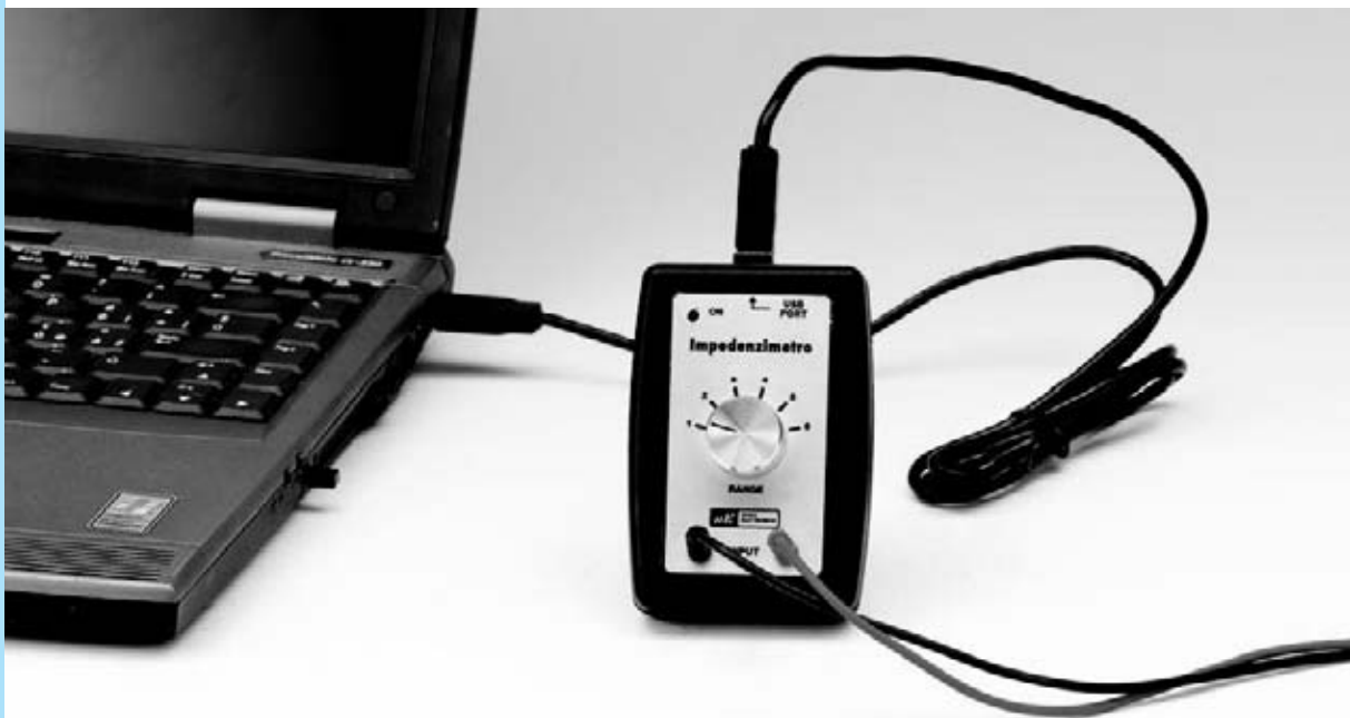
Fig.9 en la fotografía se puede ver el conmutador S1 que selecciona los 5 tipos de capacidades diferentes del instrumento. Para que no se produzcan errores en la medición, se necesita comprobar que la posición del conmutador coincida siempre con el número correspondiente seleccionado en el programa.
