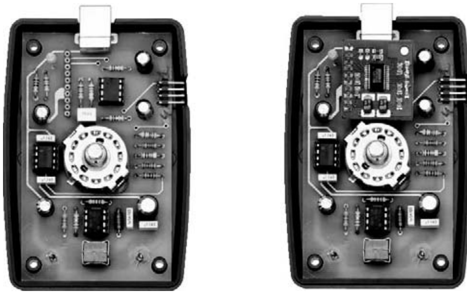
Fig.8 una vez terminado el montaje, el circuito se colocará al final del mueble, haciendo coincidir los orificios del circuito con las hendiduras de plástico, teniendo cuidado al sacar el conector CONN.3 de su lugar. A la derecha, el montaje está completando por la tarjeta KM1667 en SMD.
