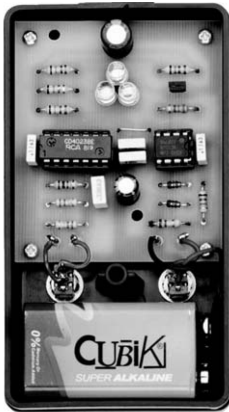
Fig.5 foto del mueble de plástico en cuyo interior están fijados el circuito impreso y la pila de alimentación de 9 voltios.
