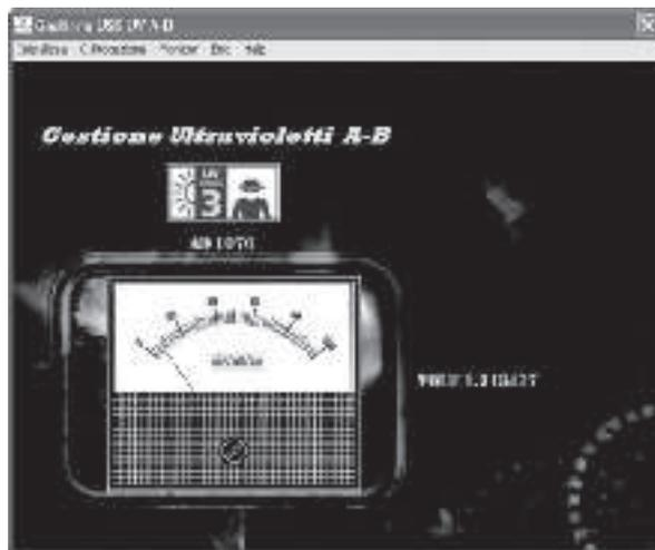
Fig.28 Se empezarán a ver los datos gracias al sensor. En el instrumento virtual aparecerá el equivalente binario de la señal que emite el sensor UVA/B y, al lado la tensión en Volt a tiempo real.
