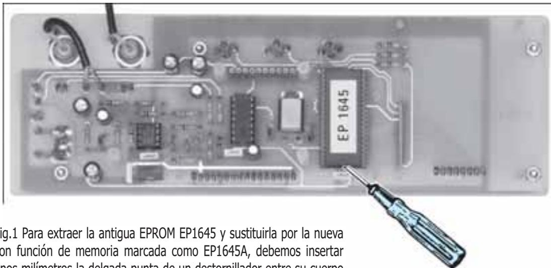
Fig.1 Para extraer la antigua EPROM EP1645 y sustituirla por la nueva con función de memoria marcada como EP1645A, debemos insertar unos milímetros la delgada punta de un destornillador entre su cuerpo y el zócalo. Esta operación se repetirá en ambos lados hasta que la EPROM quede libre. La nueva EPROM se inserta orientando su pequeña muesca de referencia en U hacia abajo.
