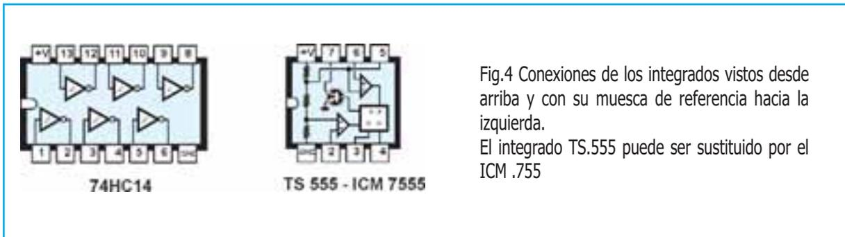
Fig.4 Conexiones de los integrados vistos desde arriba y con su muesca de referencia hacia la izquierda.
