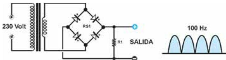
Fig.15 Para calibrar el medidor sólo necesitamos un pequeño transformador con un secundario capaz de proporcionar una tensión entre 6 y 18 voltios y un puente rectificador, para producir una frecuencia de 100 Hercios.
