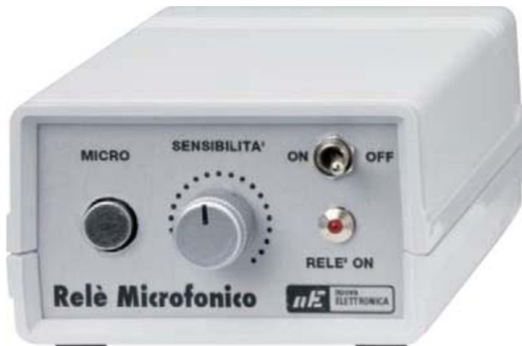
Fig.9 En el panel frontal muebles se puede apreciar el micrófono, el botón de sensibilidad, el LED y el interruptor S1 de encendido.
