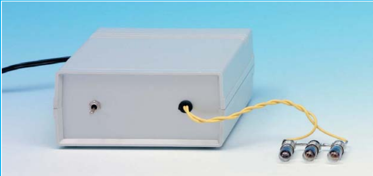
Fig.2 A los dos cables procedentes de la clema "Salida 30 voltios" (ver Fig.6) se conectan las bombillas de baja tensión. El circuito se instala dentro de un mueble de plástico para evitar que se toquen los terminales conectados a la tensión de red de 230 voltios.
