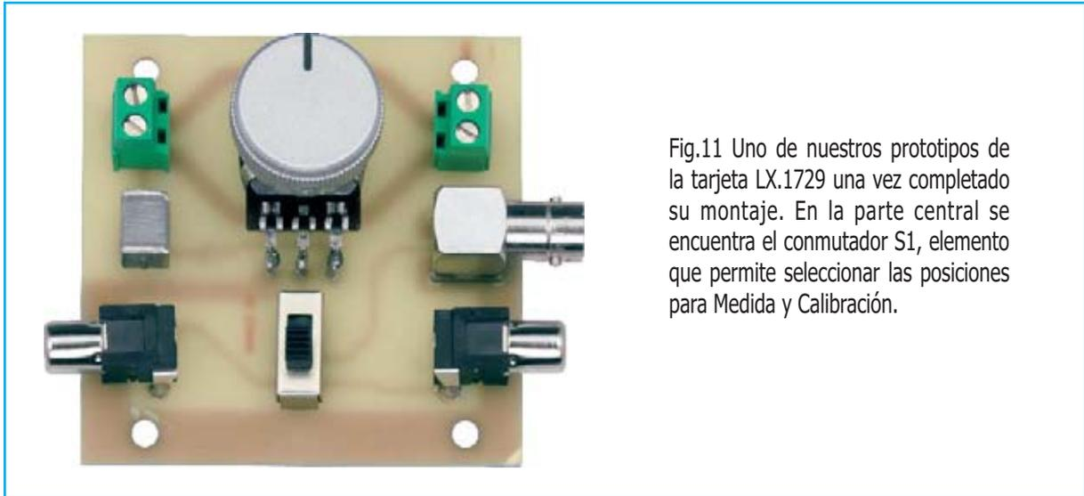
Fig.11 Uno de nuestros prototipos de la tarjeta LX.1729 una vez completado su montaje. En la parte central se encuentra el conmutador S1, elemento que permite seleccionar las posiciones para Medida y Calibración.
