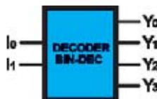
Fig.3 Esquema base del componente.
