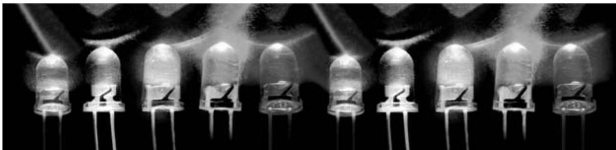
En función del color del diodo LED y de la tensión a utilizar para alimentarlo es necesario conectar en serie una resistencia que limite la corriente y que soporte la caída de tensión excedente. En este artículo enseñamos cómo calcularla.
