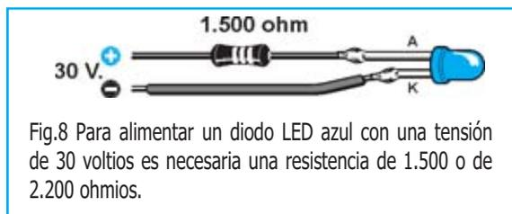
Si se desea **aumentar** su **luminosidad** se puede utilizar una resistencia de **1.500 ohmios**, para **reducirla** se puede utilizar una resistencia de **2.200 ohmios**.
