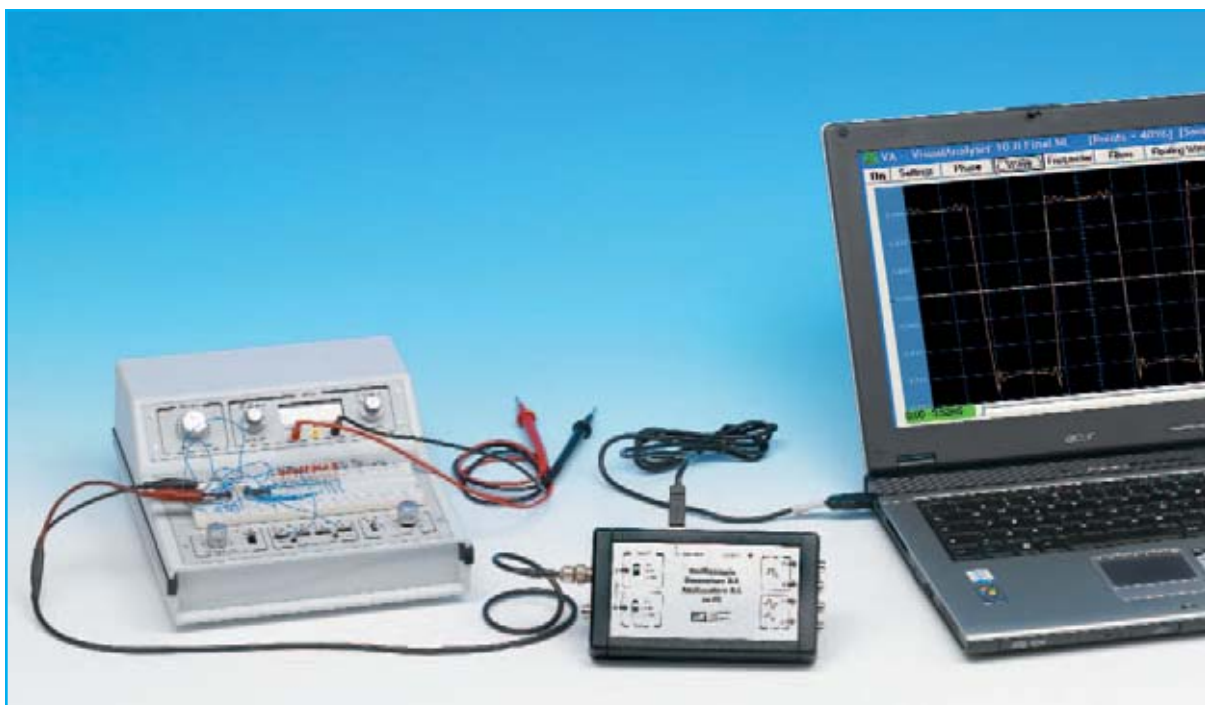
Fig.3 Conectando a la toma USB de un ordenador personal nuestro Laboratorio LX.1690, publicado en la revista Nº232, con su correspondiente software, tendréis a vuestra disposición dos instrumentos que convierten a Minilab en un auténtico laboratorio avanzado de electrónica: Un Osciloscopio y un Analizador de espectro.
