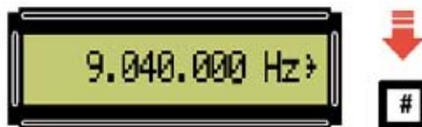
**Fig.24** Una vez escrito el número 9.040.000 hay que presionar la tecla #. Automáticamente aparecerá a la derecha el símbolo de confirmación >.
