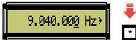
**Fig.25** Ahora hay que presionar la tecla \*, el cursor \_ se desplaza al primer dígito de la derecha. Si se utilizara el pulsador + se modificarían las unidades de Hz.
