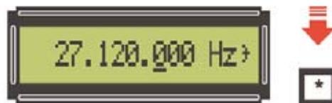
**Fig.31** Hay que ajustar las centenas de Hz, para ello hay que accionar la tecla \* hasta posicionar el cursor de selección \_ bajo el tercer dígito y utilizar el pulsador -.
