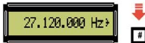
**Fig.29** Una vez escrito el número 27.120.000 hay que presionar la tecla #. Automáticamente aparecerá a la derecha el símbolo de confirmación >.
