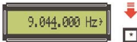
**Fig.26** Hay que ajustar las unidades de millar de Hz, para ello hay que accionar la tecla \* hasta posicionar el cursor de selección \_ bajo el cuarto dígito.
