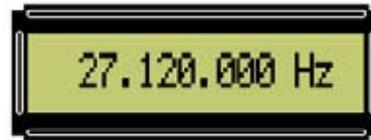
**Fig.28** Puesto que la frecuencia overtone de un cuarzo de 27.120.000 Hz en 3ª armónica es exactamente este valor hay que escribir en el teclado el número 27.120.000.
