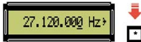
**Fig.30** Ahora hay que presionar la tecla \*, el cursor \_ se desplaza al primer dígito de la derecha. Si se utilizara el pulsador + se modificarían las unidades de Hz.
