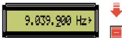
**Fig.27** Una vez alcanzado el número 9.044.000 para conseguir una mayor precisión hay que ajustar las centenas de Hz ya que el valor de la frecuencia es 9.039.900 Hz.
