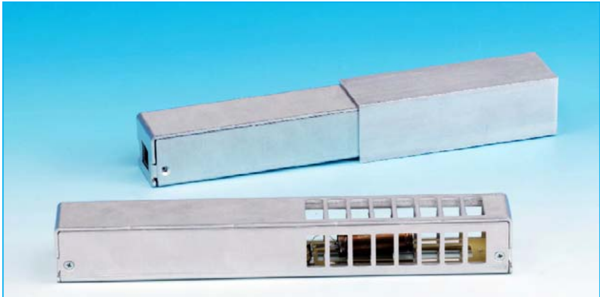
Fig.42 En la fotografía se muestra la sonda de medida con sus dos posibles formas de utilización. En la parte inferior se muestra sin pantalla metálica instalada, de esta forma se miden todas las radiaciones presentes. En la parte superior se muestra la sonda con la pantalla metálica instalada, de esta forma se miden solo las radiaciones gamma ya que las radiaciones alfa y beta quedan apantalladas.
