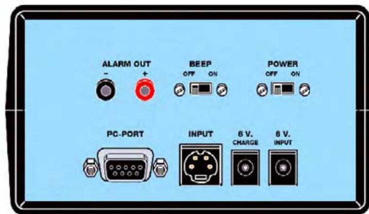
Fig.40 En este segundo esquema se muestran todos los elementos del panel posterior del mueble contenedor del contador Geiger LX.1710.
