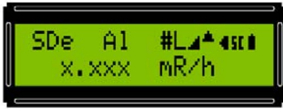
Fig.41 Detalle de la posición y significado de cada uno de los símbolos y referencias que pueden aparecer en el display durante el funcionamiento del contador Geiger.
