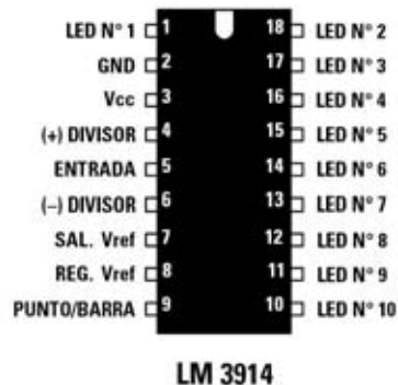
Fig.5 Conexiones del integrado LM.3914 (IC3) y del integrado TL081 (IC1), vistas desde arriba y con la muesca de referencia orientada hacia la parte superior. El integrado IC2 (L.7805 o uA.7805) se muestra frontalmente. El terminal más largo de los diodos LED es el ánodo (A), que se conecta a la tensión de 12 voltios, mientras que el terminal más corto es el cátodo (K), que se conecta a las salidas de IC3.
