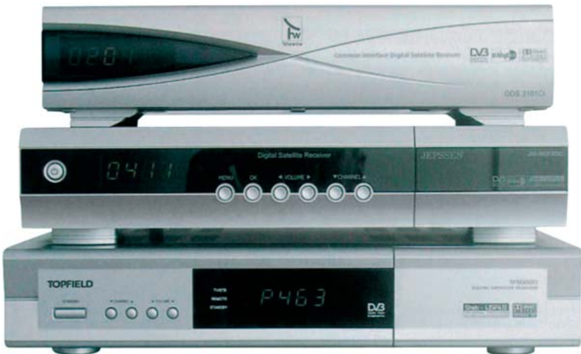
Fig.8 Para poder recibir señales digitales es preciso un Decodificador que se conecta al televisor mediante un conector Scart (ver Fig.3). Los decodificadores para satélite incorporan un lector de tarjetas ya que las emisiones suelen ser codificadas y de pago. En cambio los decodificadores para televisión digital terrestre (TDT) no incorporan lector de tarjeta ya que las emisiones son en abierto y gratuitas.
