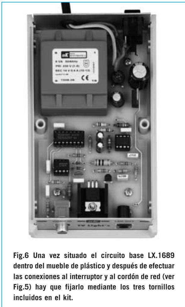
Fig.6 Una vez situado el circuito base LX.1689 dentro del mueble de plástico y después de efectuar las conexiones al interruptor y al cordón de red (ver Fig.5) hay que fijarlo mediante los tres tornillos incluidos en el kit.
