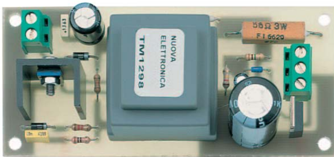
Fig.4 Fotografía del prototipo del circuito con todos sus componentes montados. En la parte superior-izquierda se encuentra la clema de dos polos utilizada para la conexión a la batería de 12 voltios, o bien a un alimentador estabilizado capaz de proporcionar una tensión de 12 voltios con 0,5 amperios. El transistor TR1, situado en la parte izquierda del circuito, ha de instalarse con una pequeña aleta de refrigeración.
