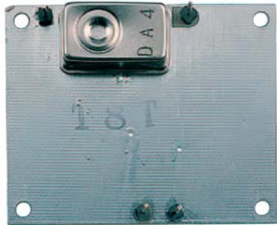
Fig.3 Aspecto de la placa del sensor por radar, vista por la parte posterior. En este caso se aprecia con claridad el pequeño módulo DRO.
