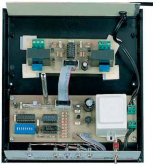
Fig.5 Dentro del mismo mueble se aloja la tarjeta del Receptor LX.1410 y la tarjeta de 2 relés mostrada en la Fig.3.
