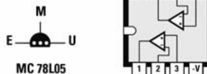
Fig.3 Conexiones del estabilizador de tensión MC.78L05, vistas desde abajo, y del doble operacional TL.082, vistas desde arriba. En el terminal 1 del integrado TL.082 hay una tensión constante de 2,5 voltios, mientras que en el terminal 7 hay una tensión que varía +/- 1,3 milivoltios por cada gauss detectado.
