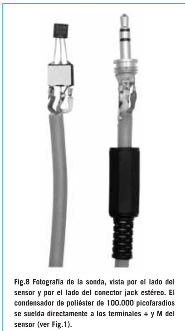
Fig.8 Fotografía de la sonda, vista por el lado del sensor y por el lado del conector jack estéreo. El condensador de poliéster de 100.000 picofaradios se suelda directamente a los terminales + y M del sensor (ver Fig.1).
