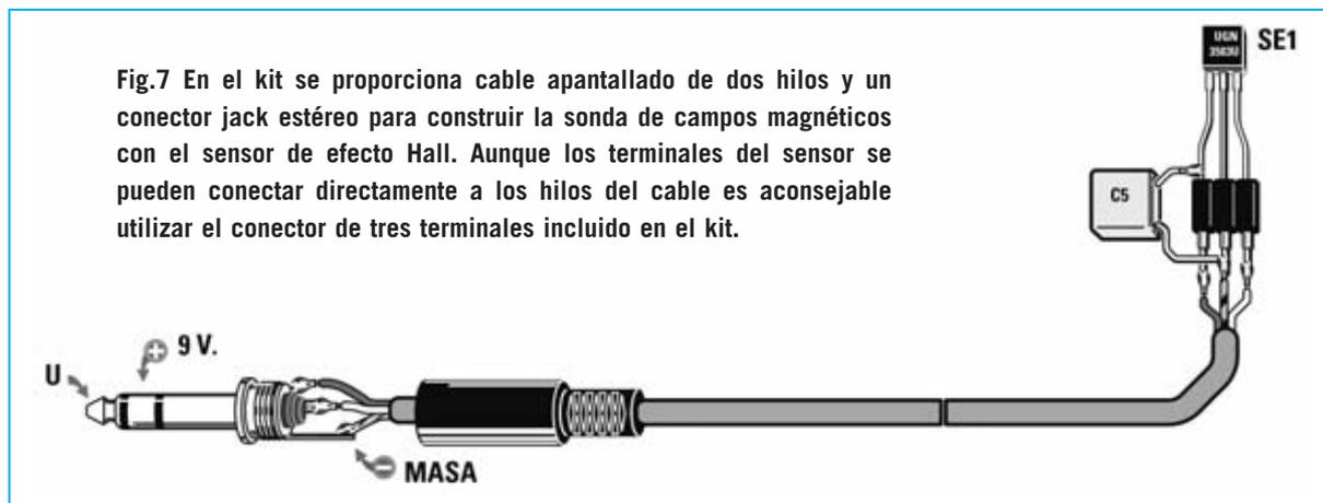
Fig.7 En el kit se proporciona cable apantallado de dos hilos y un conector jack estéreo para construir la sonda de campos magnéticos con el sensor de efecto Hall. Aunque los terminales del sensor se pueden conectar directamente a los hilos del cable es aconsejable utilizar el conector de tres terminales incluido en el kit.
