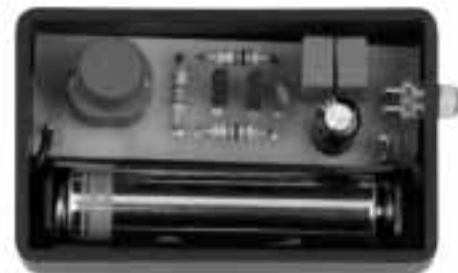
Fig.8 Esquema práctico de montaje del circuito mostrado en la Fig.3. El diodo DS1 se conecta al cable procedente del agujero A, orientando su lado marcado con una franja negra hacia el exterior. El terminal positivo del condensador electrolítico C3 se conecta al diodo, mientras que el terminal negativo se conecta al cable procedente del agujero K.
