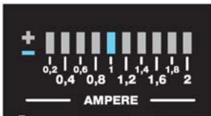
Fig.9 Si el téster mide 1 amperio y el trimmer R5 se ajusta para encender el diodo LED DL5, el diodo LED correspondiente al fondo de escala (DL10) se enciende cuando la corriente tiene un valor de (1 : 5) \times 10 = 2 amperios.
