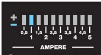
Fig.8 Si el téster mide 1 amperio y el trimmer R5 se ajusta para encender el diodo LED DL2, el diodo LED correspondiente al fondo de escala (DL10) se enciende cuando la corriente tiene un valor de (1 : 2) \times 10 = 5 amperios.
