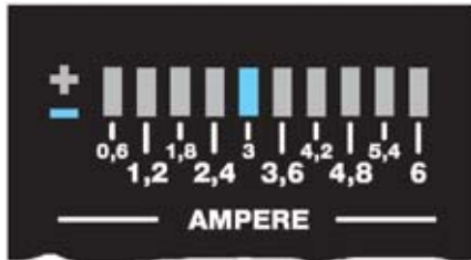
Fig.11 Si el t ester mide 3 amperios y el trimmer R5 est  ajustado para encender el diodo LED DL5, los diodos LED se encienden con saltos de 0,6 amperios, correspondiendo el fondo de escala a un valor de 6 amperios.
