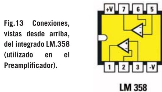
Fig.13 Conexiones, vistas desde arriba, del integrado LM.358 (utilizado en el Preamplificador).
