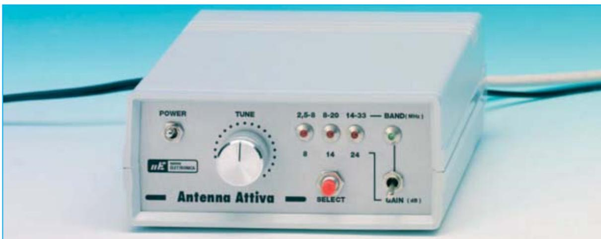
Fig.1 Aspecto de la Central de Control LX.1657. Este dispositivo ha de instalarse en proximidad al receptor que se quiere sensibilizar (ver Fig.2). El conmutador S1 (BAND/GAIN) y el pulsador P1 (SELECT) permiten seleccionar el rango de frecuencias a amplificar y la ganancia.
