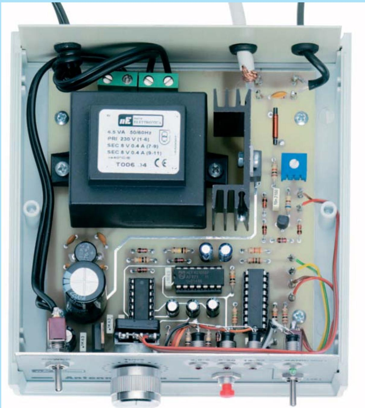
Fig.16 Fotografía del Circuito impreso LX.1657 instalado dentro de su mueble de plástico y del mueble contenedor una vez cerrado. El trimmer R3 y el potenciómetro R1 (TUNE) se utilizan para variar el valor de la tensión presente en los diodos varicap, por lo tanto para seleccionar la frecuencia de sintonía.
