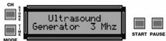
A continuación se escucha un breve **pitido** para verificar el funcionamiento del buzzer. Después desaparece el texto inicial del display para mostrar los parámetros de trabajo.
