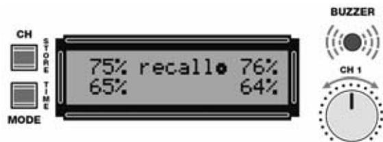
Después de regular el canal **CH1** hay que presionar de nuevo la tecla **CH**. El asterisco se desplaza hacia abajo indicando que ha sido seleccionado el canal **CH2**.
