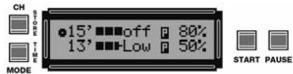
**NOTA:** La verificación de la presencia del difusor se efectúa únicamente al **encender** el instrumento. Esta operación también puede ser útil para comprobar el **correcto funcionamiento** de los difusores y del Generador de ultrasonidos. Si después de conectar los difusores al Generador aparece en el display la indicación **OFF** significa que el difusor no funciona correctamente o bien que hay un problema en la etapa final de potencia del Generador.
