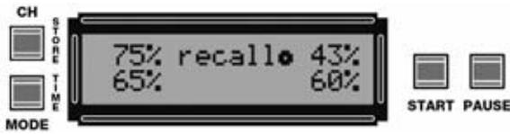
El asterisco mostrado al lado de **RECALL** se posiciona sobre el canal **CH1** para indicar que tenemos que realizar la regulación del potenciómetro correspondiente a este canal.
