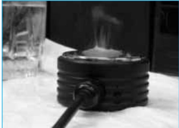
Fig.26 Poniendo una gota de agua sobre la superficie del difusor del Generador de ultrasonidos de 1 MHz se consigue un efecto pulverizador bastante visible.
