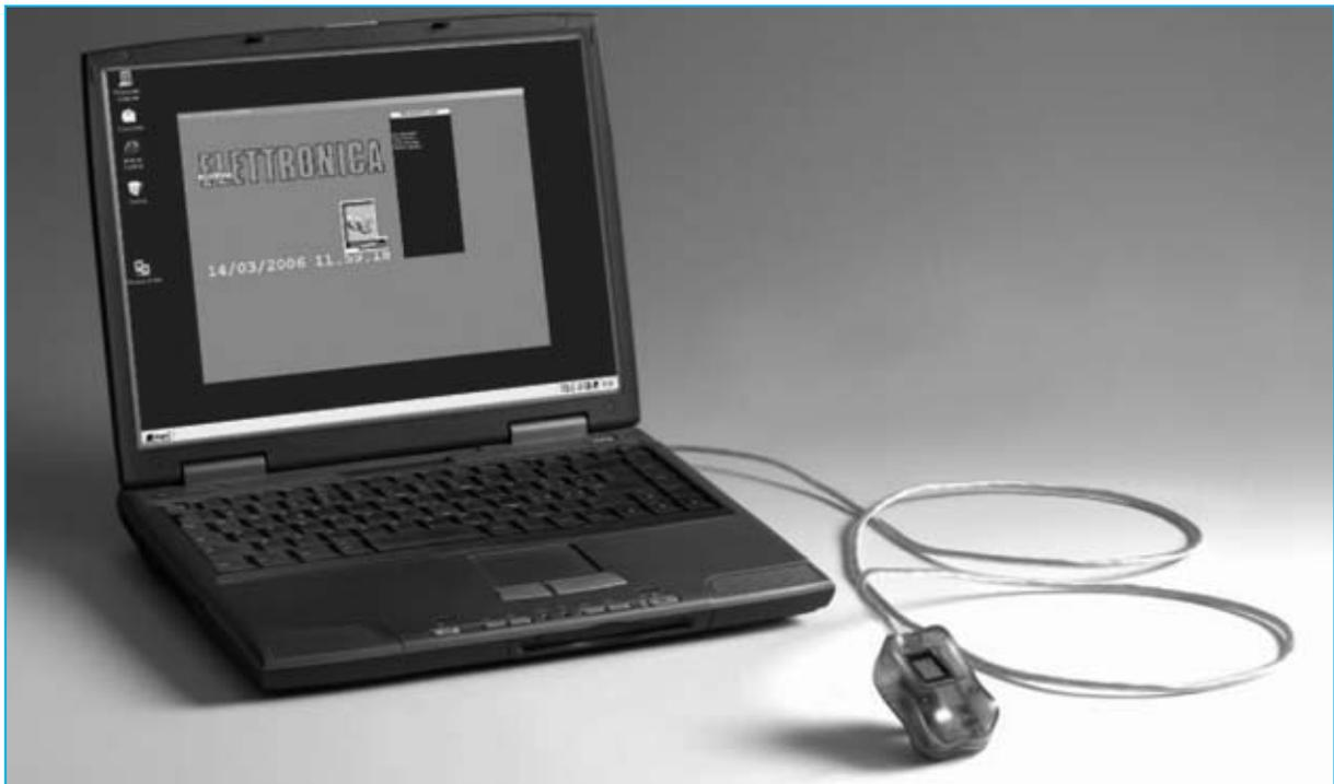
Fig.1 Aspecto del lector de huellas KM.1626 conectado al puerto USB de un ordenador portátil.
