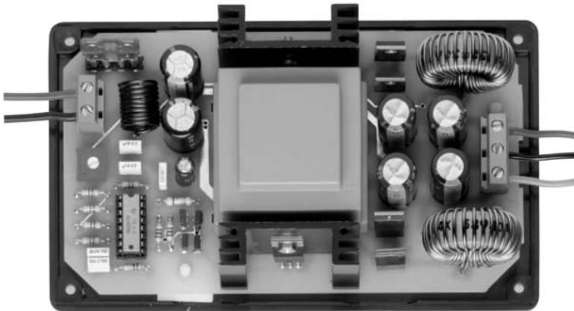
Fig.7 El mueble de plástico MTK09.03 está dimensionado para contener el alimentador conmutado. El circuito se fija en el fondo del mueble utilizando los 4 separadores de plástico con base autoadhesiva incluidos en el kit. Antes de cerrarlo, hay que realizar una serie de agujeros en la tapa y en los laterales para asegurar la ventilación (ver Fig.10).
