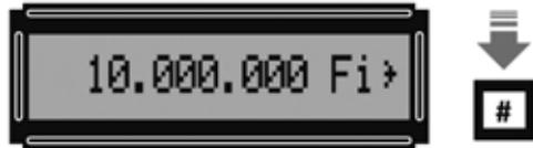
Fig.41 Para cambiar la frecuencia inicial hay que pulsar 3 veces en la tecla MODE, así aparecerá la indicación 0 Fi. Ahora ya solo hay que escribir el nuevo valor, por ejemplo 10.000.000.
