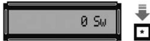
Fig.43 Para seleccionar la velocidad en el barrido hay que utilizar la tecla \*. En el display aparece la indicación 0 Sw (Sweep).
