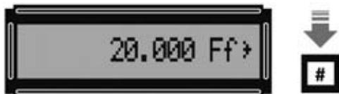
Fig.37 Hay que introducir un valor, por ejemplo 20.000. A continuación hay que confirmar con la tecla #. En el display aparecerá la indicación 20.000 Ff > (Frecuencia final 20.000 Hz).
