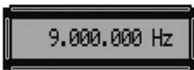
Fig.22 Si en el display aparece una frecuencia de 85.000.000 Hz > pero se quiere obtener una frecuencia de 9.000.000 Hz solo hay que escribir este número y, a continuación, pulsar la tecla # como confirmación. En el display aparecerá el símbolo > indicando que la operación ha sido confirmada.
