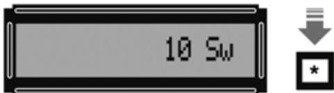
Fig.39 Utilizando la tecla \* se puede elegir la velocidad de barrido: 1-10-100-1.000 ...
