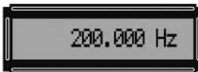
Fig.20 Para seleccionar la frecuencia presente en la salida, una vez que tras encender el Generador aparece en el display el valor 0 Hz inicial, hay que escribir el valor deseado en Hertzios. Por ejemplo, para obtener 200 KHz hay que escribir 200.000 Hz, y, a continuación, pulsar la tecla # como confirmación. En el display aparecerá el símbolo > indicando que la operación ha sido confirmada.
