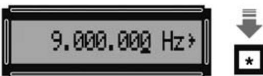
Fig.24 Si en el display aparece una frecuencia de 9.000.000 Hz > y se quiere modificar en unos pocos Hertzios, hay que pulsar la tecla \*. De esta forma la cifra situada más a la derecha se activa (aparece subrayada).
