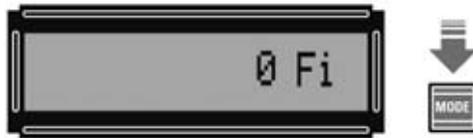
Fig.34 Una vez que en el display aparece el valor inicial 0 Hz hay que pulsar 2 veces la tecla MODE. En el display aparece la indicación Fi (Frecuencia inicial).
