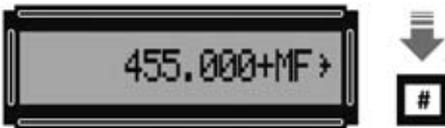
Fig.48 Ahora hay que escribir, en Hertzios, el valor de la MF que se desea sumar y presionar la tecla # de confirmación.
