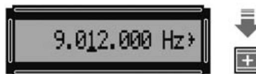
Fig.29 Una vez que se llega a 9.009.000 Hz si se mantiene presionada la tecla + la frecuencia sigue subiendo. Si se presiona la tecla - la frecuencia disminuye.
