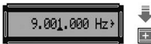
Fig.28 Presionando la tecla + la frecuencia aumenta 1.000 Hz cada vez. Incluso aunque se llegue a 9.009.000 Hz la frecuencia continuará subiendo en saltos de 1.000 Hz.
