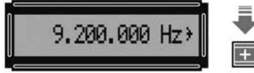
Fig.32 Presionando la tecla + la frecuencia siempre aumenta con saltos de 100.000 Hz (100 KHz). Accionando la tecla - la frecuencia disminuye en saltos de 100 KHz.
