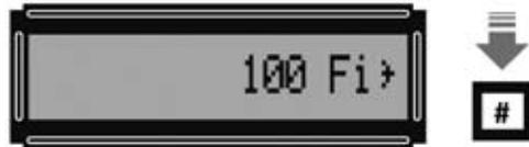
Fig.35 Hay que introducir un valor, por ejemplo 100. A continuación hay que confirmar con la tecla #. En el display aparecerá la indicación 100 Fi > (Frecuencia inicial 100 Hz).
