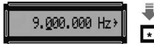
Fig.30 Para variar la frecuencia en saltos de 100.000 Hz con las teclas +/- hay que presionar la tecla \* hasta que quede activada (subrayada) la sexta cifra empezando por la derecha. A continuación hay que utilizar las teclas +/-.
