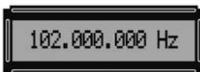
Fig.21 Si una vez seleccionado el valor de 200.000 Hz se quiere obtener en la salida del Generador DDS una señal con una frecuencia de 102.000.000 Hz (102 MHz) únicamente hay que escribir el número y, a continuación, pulsar la tecla # como confirmación. En el display aparecerá el símbolo > indicando que la operación ha sido confirmada.
