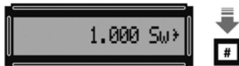
Fig.45 Una vez seleccionado el valor 1.000 Sw, para que comience la ejecución de la función de barrido (Sweep) hay que pulsar la tecla de confirmación #. En el display se mostrará el signo >.
