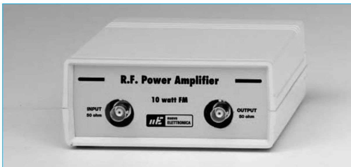
Fig.14 Aspecto final del Lineal una vez integrado dentro de su mueble contenedor. En el panel frontal se encuentran el BNC de Entrada (INPUT), al que hay que aplicar la señal RF proveniente del Excitador FM KM.1619, y el BNC de Salida (OUTPUT), donde se obtiene la señal a aplicar al dipolo irradiante (ver Fig.15).
