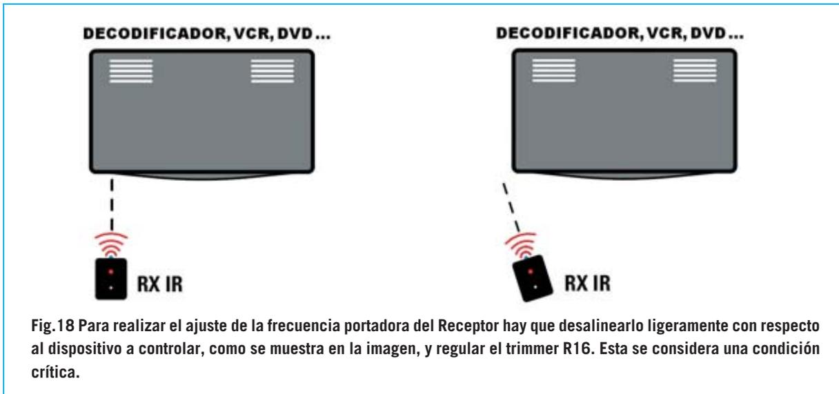
Fig.18 Para realizar el ajuste de la frecuencia portadora del Receptor hay que desalinearlo ligeramente con respecto al dispositivo a controlar, como se muestra en la imagen, y regular el trimmer R16. Esta se considera una condición crítica.
