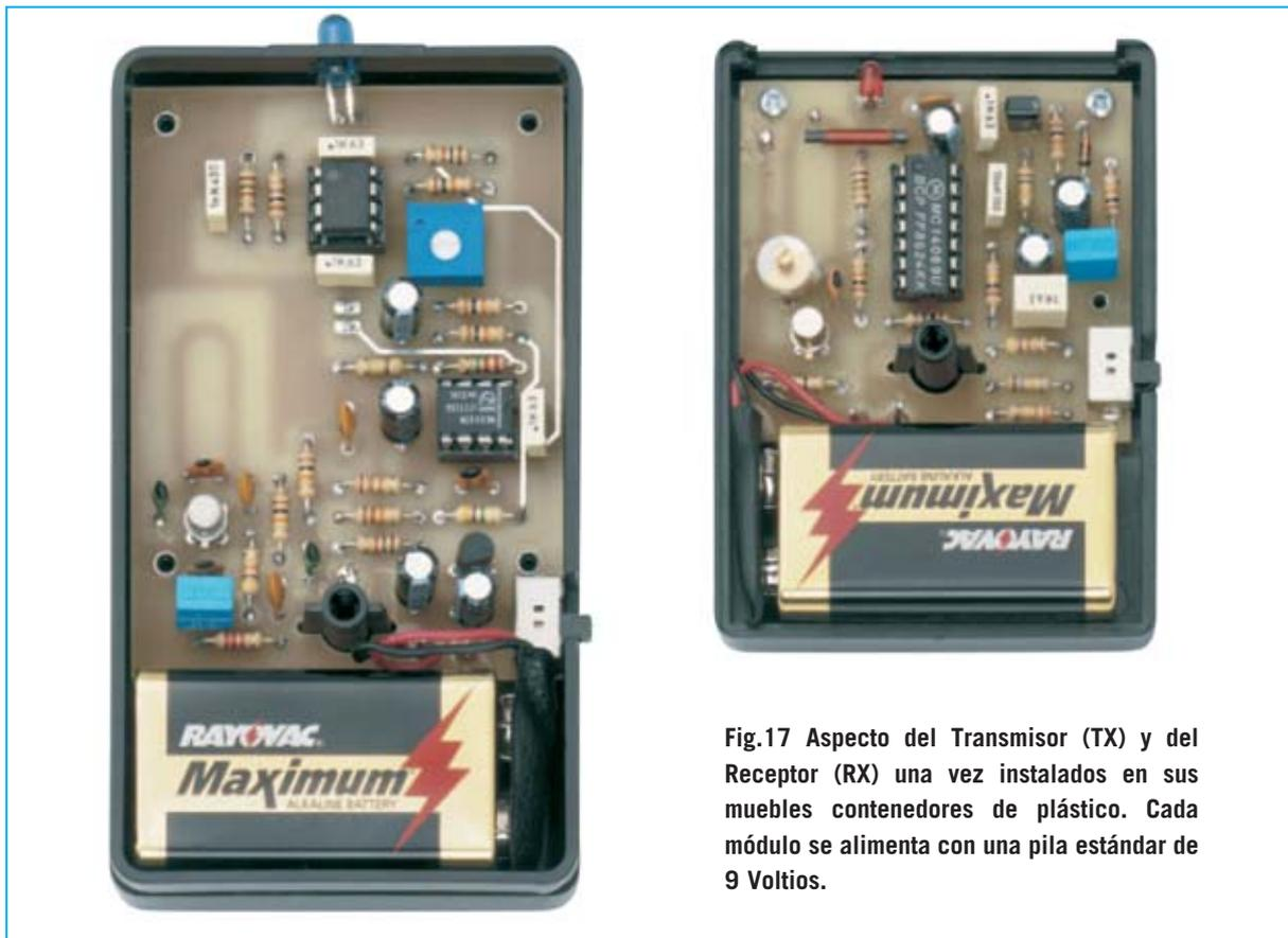
Fig.17 Aspecto del Transmisor (TX) y del Receptor (RX) una vez instalados en sus muebles contenedores de plástico. Cada módulo se alimenta con una pila estándar de 9 Voltios.
