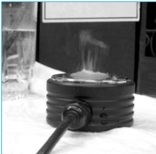
Fig.21 Para verificar el correcto funcionamiento del difusor se pueden depositar, con el generador apagado, unas gotas de agua sobre él. A continuación hay que encender el generador y pulsar el botón START/PAUSE. Si todo funciona correctamente el difusor convertirá las gotas de agua en vapor. Una vez realizada esta sencilla comprobación hay que apagar el generador.
