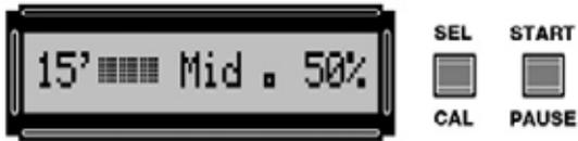
3. Trabajar de **modo pulsaciones HIGH** correspondiente a un duty-cycle del **75%**. Para activar esta función hay que **presionar** de nuevo el pulsador **SEL/CAL**. Girando el mando **POWER** hay que seleccionar a continuación el % de **potencia** a utilizar.
