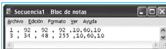
**Fig.30** Haciendo click en el botón **EDIT** (ver Fig.26) se pueden editar las secuencias salvadas como archivo **.txt**. El primer número de cada línea corresponde al número de la lámpara, los tres valores siguientes corresponden a **SLOPE UP, LINEAR-LIGHT** y **SLOPE DOWN**, y, por ultimo, se encuentran los tiempos de programación (en segundos).
