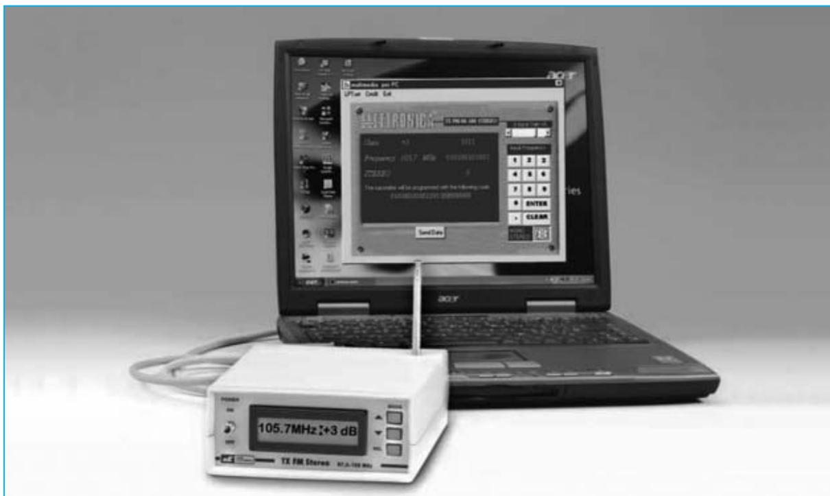
El mismo conector BNC **SALIDA 75 Ohm**. también se puede utilizar para aplicar la **señal RF** a la entrada de una etapa **final de potencia**.
