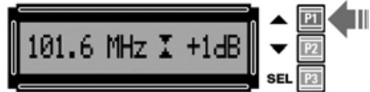
Fig.22 Para aumentar la frecuencia de transmisión únicamente hay que pulsar la tecla superior (P1).
