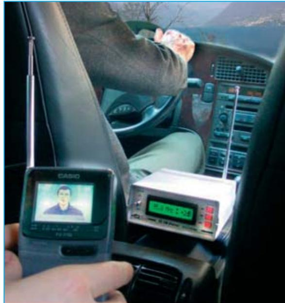
**Fig.5 Conectando el Excitador FM a la toma de audio de un pequeño televisor portátil se puede utilizar el equipo Hi-Fi de vuestro coche o autocaravana para potenciar el sonido.**
