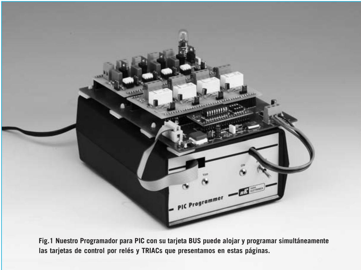
Fig.1 Nuestro Programador para PIC con su tarjeta BUS puede alojar y programar simultáneamente las tarjetas de control por relés y TRIACs que presentamos en estas páginas.
