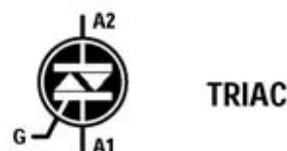
Fig.4 En esta figura se muestra el símbolo eléctrico del TRIAC. Sus terminales de denominan Puerta (G), Ánodo 1 (A1) y Ánodo 2 (A2).
